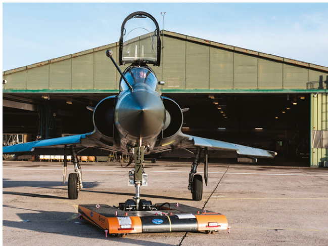
Expérimentation de tractage assisté d'aéronefs lancée par l'Innovation Défense Lab par et pour l'Armée de l'air, afin d'automatiser et de simplifier certaines fonctions comme l'approche de l'avion.
