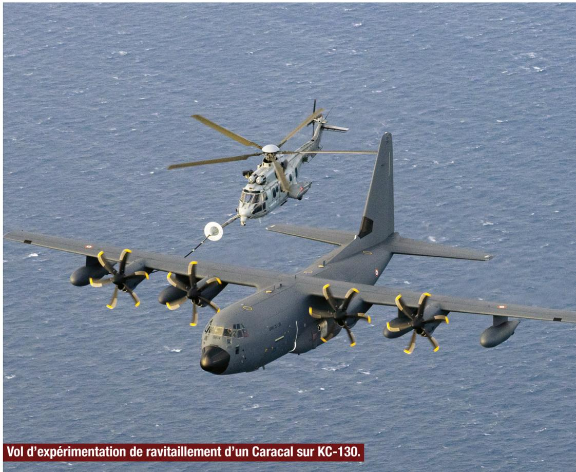
Vol d'expérimentation de ravitaillement d'un Caracal sur KC-130.
