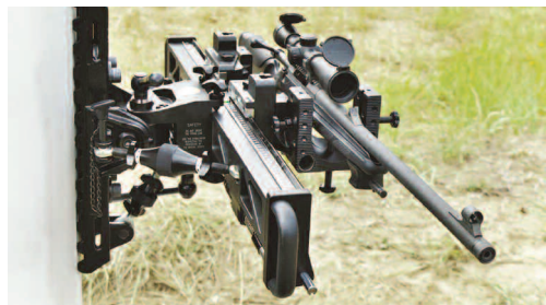
Banc de test et de réglage pour armes légères Stabilisator 3000 A1® (référence Otan : 1290-14-4834878-Stabilisator 3000 AEL-FA2N4)
