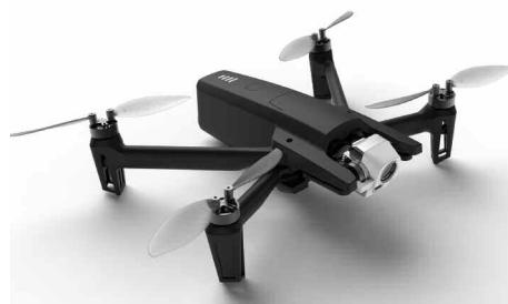
Drone Parrot Anafi2 : caméra 21Mpixels avec zoom et caméra FLIR Lepton sur la tête gyrostabilisée
