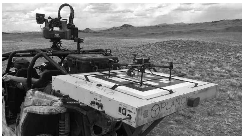
Drone développé par la société Planck et sa plateforme de récupération automatique qui fonctionne même pendant la marche du véhicule
