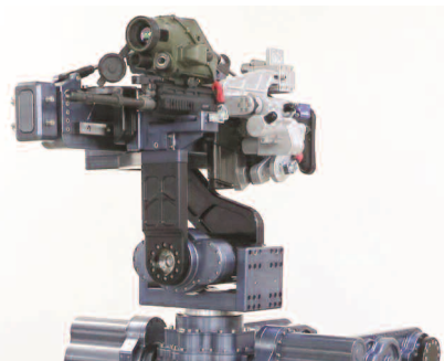
À gauche, Snibot ® SCAR308 - cal. 7,62 x 51 mm – version à chenilles À droite, prototype « 2015 » de la Pièce-feu du Snibot ® SCAR308 (sans son carter carbone)
