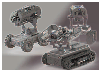
À gauche, Mini-Snibot ® MS90 - cal. 5,7 x 28 mm - versions à roues et à chenilles À droite, prototype « 2018 » de la Pièce-feu du Mini-Snibot ® MS90
