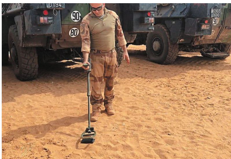
Démonstration par un sapeur du 6 e RG d'Anger de l'utilisation d'un détecteur à haut pouvoir magnétique (DHPM). | CREDIT PHOTO : OUEST-FRANCE
