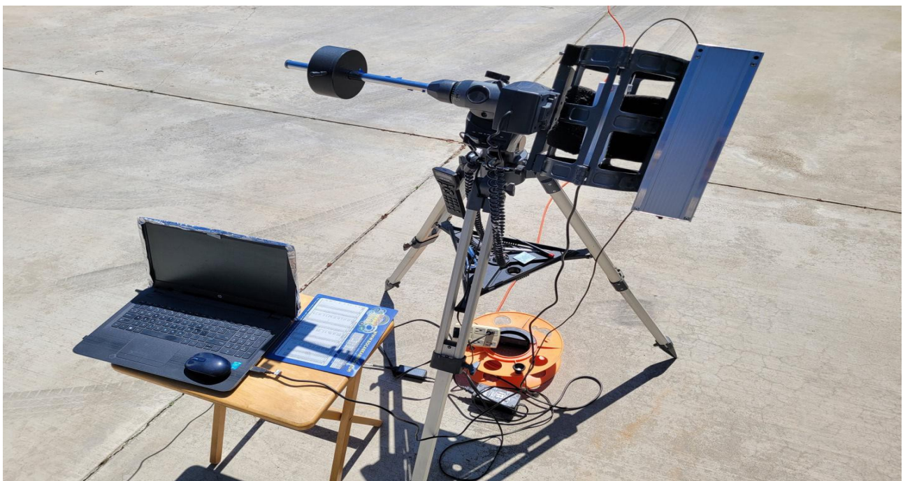
Figure 7. Double monochromateur fixé au rail de montage supérieur de la monture annulaire du télescope. L'ILT950UV se trouve à l'intérieur de la monture annulaire.
