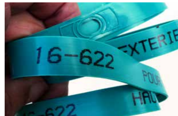
Les dimensions du fond de jante. Ici, largeur de 16 mm pour jante de 622 mm de diamètre.
