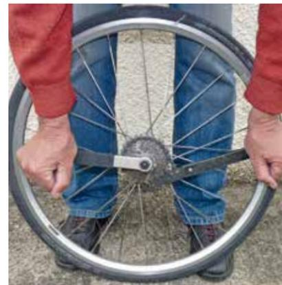
• Lorsque l'écrou est débloqué, retirer le fouet à chaîne et placer la roue horizontalement sur une table. Dévisser l'écrou avec le démonte-cassette, puis à la main avant de le retirer.
