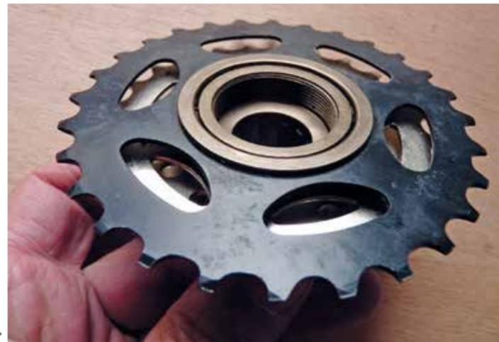
D'une façon générale, une roue libre est composée de deux parties distinctes : la roue libre proprement dite ou le corps, et les pignons sur lesquels s'enroule la chaîne.
