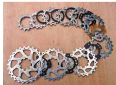
• Après avoir nettoyé et inspecté chaque pignon et entretoises, nettoyer le corps de la roue libre et l'espace compris entre le corps et les rayons (c'est le moment ou jamais !). Terminer par le nettoyage de l'écrou, et le pas de vis intérieur.
