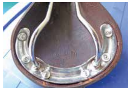
Ancien cuir, posé sur un nouveau rail.
