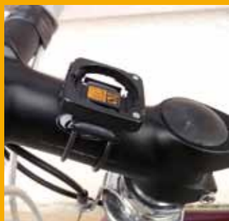
Système Sigma, Twist-lock qui permet de fixer le compteur sur son support simplement.
