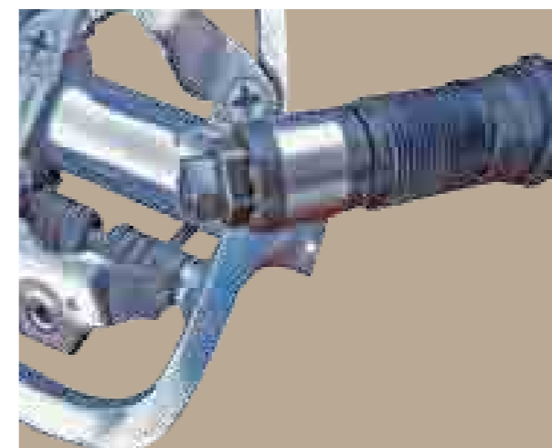
Pédale Shimano PD-A520 : les roulements sont fixés sur l'axe et le tout est vissé dans le corps de la pédale. L'ensemble est démontable grâce au petit écrou de bout d'axe
