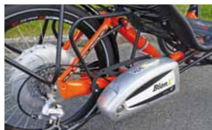
La batterie et le moteur dans le moyeu.
