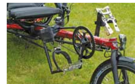
Pédales spéciales : réglables, elles peuvent recevoir de larges chaussures comme les chaussures orthopédiques. Ici, la pédale droite est équipée d'un support pour le mollet.
