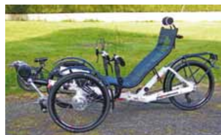
Autre Tricycle Azub avec assistance Sunstar. Le moteur est ici dans le pédalier.
