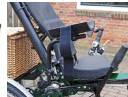
Un support est prévu pour le bras droit, les commandes sont groupées sur la poignée gauche.
