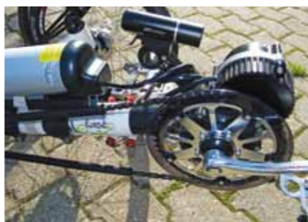
Autre Tricycle Azub avec assistance Sunstar. Le moteur est ici dans le pédalier.
