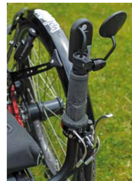
La poignée gauche regroupe la commande de frein et celle d'un moyeu Rohloff, le tout actionné par une seule main.
