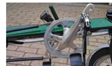
La manivelle comporte plusieurs trous pour la pédale, la longueur de la manivelle est donc modulable.
