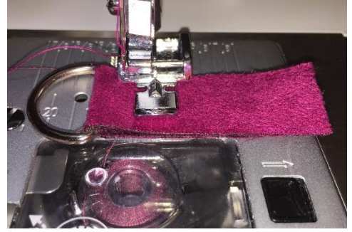
Piquer au plus près grâce au pied spécial fermetures.
