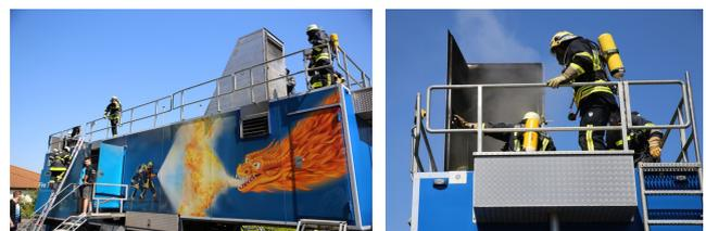
Im Inneren des mobilen Brandsimulationscontainers "Dragon Fire" ist eine Übungsstrecke mit gasbefeuerter Brandstellen mit variablen Flammengrößen, die Simulation einer Rauchgas-Durchzündung, sowie eine komplette Vernebelung der Räume mit Rauchgeneratoren installiert. Alle Einsatzkräfte können hier realistisch erfahren, wie es sich anfühlt und wie man reagieren muss, wenn sich ein Brand in einem kleinen und beengten Raum rasch ausbreitet.
