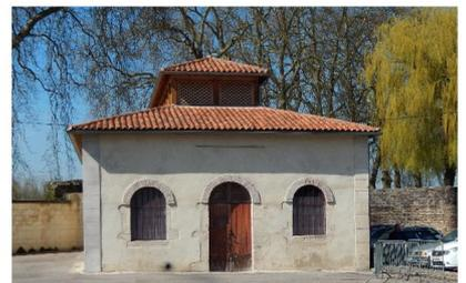
La tuile canal, courante en Saône et Loire et dans le sud de la France, est utilisée dans nos régions pour les toitures plates, ici sur un Pavillon d'octroi datant de 1840 (Bd Pasteur) et sur l'Abattoir (rue du Château) construit en 1842 et restauré en 2012 (Chantier Avenir-Environnement)
