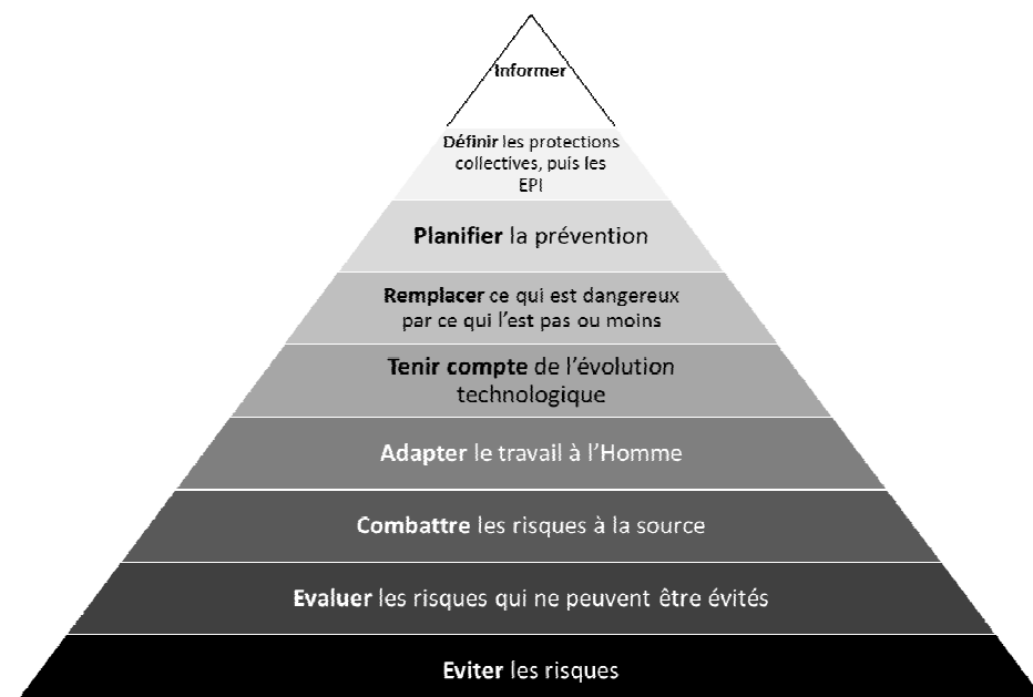
Les 9 principes généraux de prévention des risques professionnels (code du travail article L.4121-2)
