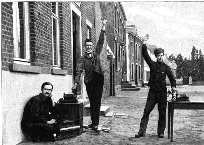
Fig. 1. — Trois aides réalisant la télégraphie sans fil avec le corps humain comme antennes.
