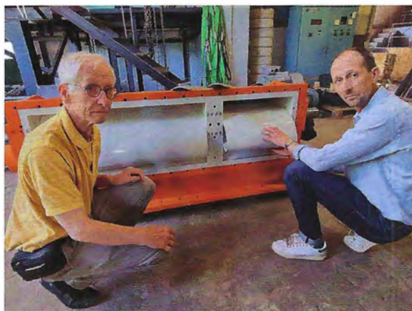
André et Jérôme Dubois devant leur dernière réalisation : une turbine Banki de 116 kW, commandée par une collectivité. Photo : Franck Turlan
