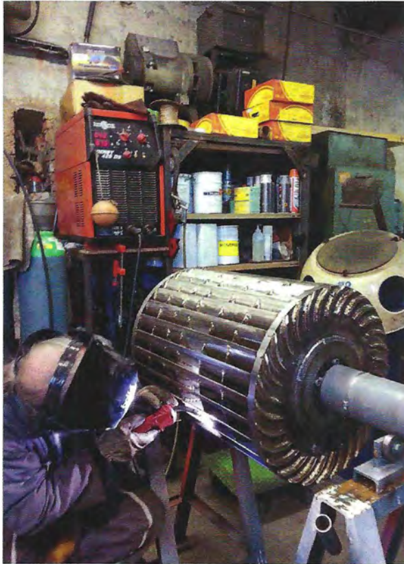
Une roue à aubages profilés avant traitement dont les pièces sont assemblées dans l'atelier de l'entreprise. Photo : sarl Shem
