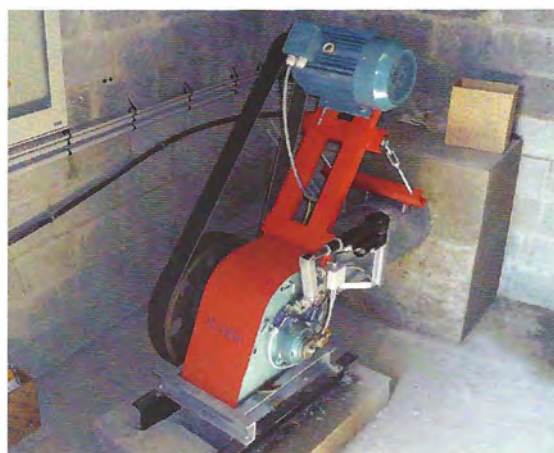
La JLA Kit existe en 3 largeurs avec un rotor de 30 cm de diamètre pour délivrer une puissance de 2 à 20 kW. Photo : JLA Hydro
