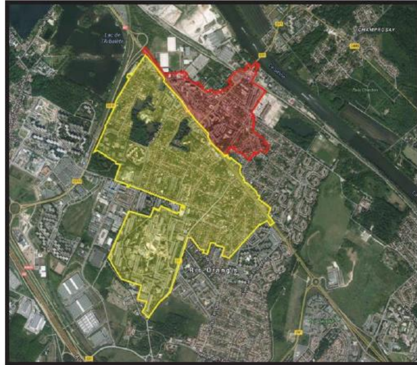
Fig. 8. Bassins versants interceptés par la zone de projet
