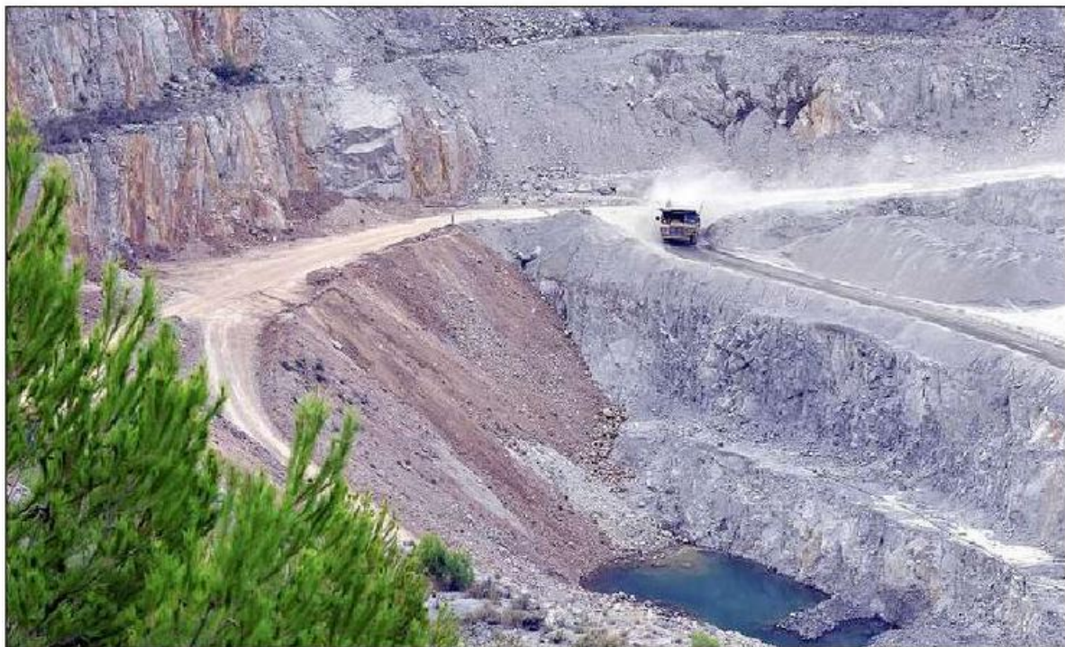
La terre et les roches (un peu plus rouges) apportées par les entreprises de terrassement remblaient une partie du site. Le lac remplira ce trou en 2042.
