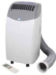
Les climatiseurs monoblocs sont des appareils compacts, en un seul bloc avec le compresseur intégré. Leurs principaux avantages sont leur simplicité d'utilisation et leur prix (à partir de 300€). En contrepartie, ces climatiseurs sont relativement bruyants (55dB et plus), pas très puissants et doivent avoir un gros tuyau qui sort à l'extérieur pour évacuer l'air chaud (porte ou fenêtre doivent rester ouvertes ce qui n'est pas très pratique pour les appartements en rez de jardin).
