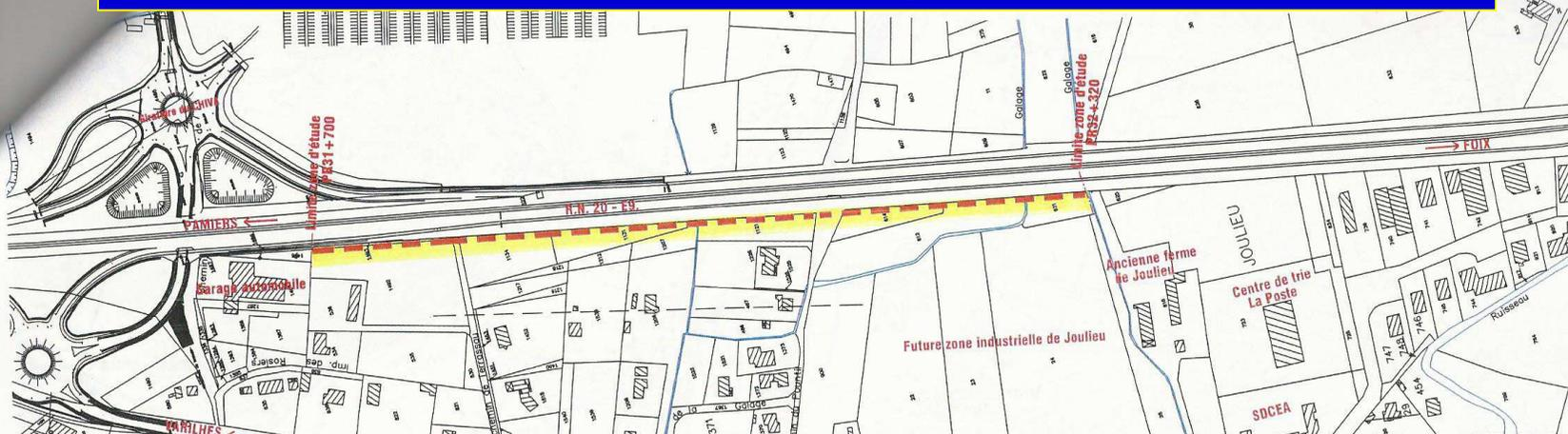
Merlon sur environ 620 m (du garage automobile jusqu'à l'ancienne ferme de « Joulieu ». Hauteur de 4 m : Urbanisme, propriétés, réseau routier, réseau hydraulique, le végétal, topographie-terrain naturel...
