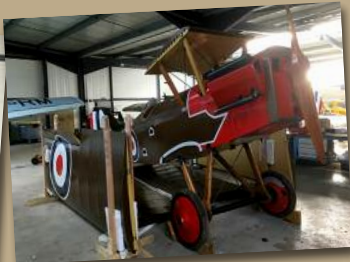
Contrôle des haubans et mats du Se-5a
