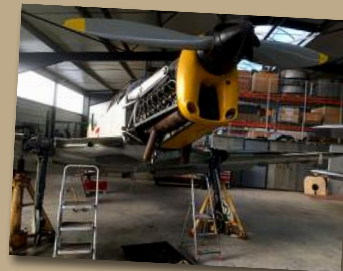
Vérification du train du P2 sur vérins
