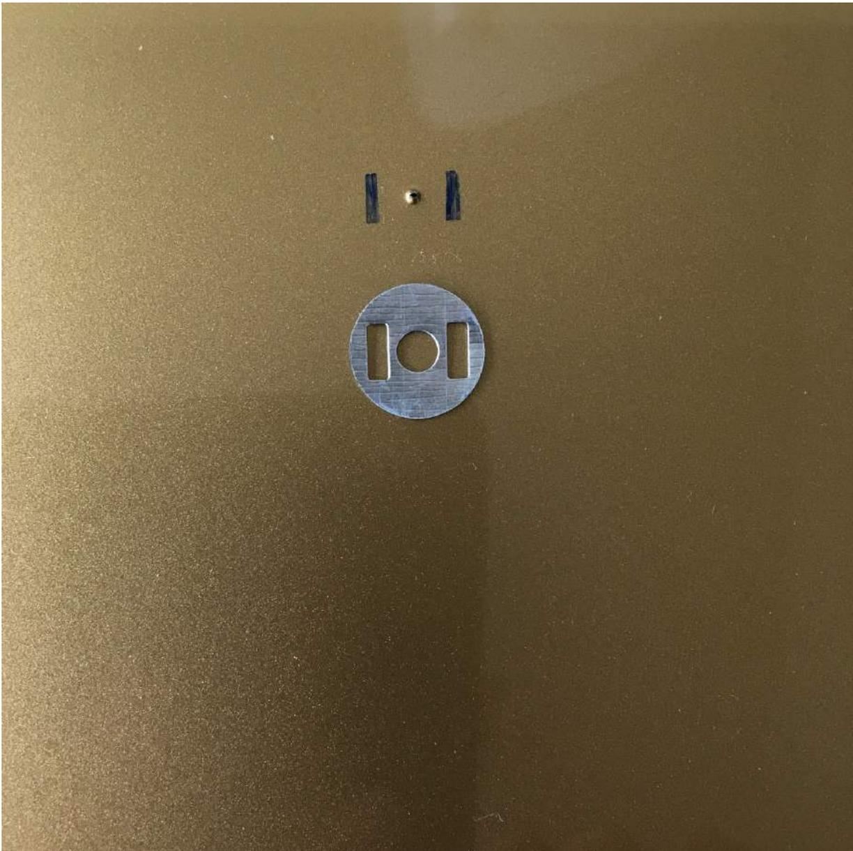
Couper 2 fentes au cutter sur chaque repère et insérer les fermetures aimantées.
