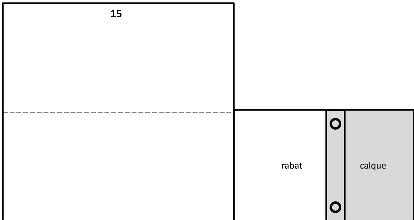
Collez le morceau de calque sur le rabat en collant une bande d'1 cm, placez deux œillets, un en haut, un en bas.
