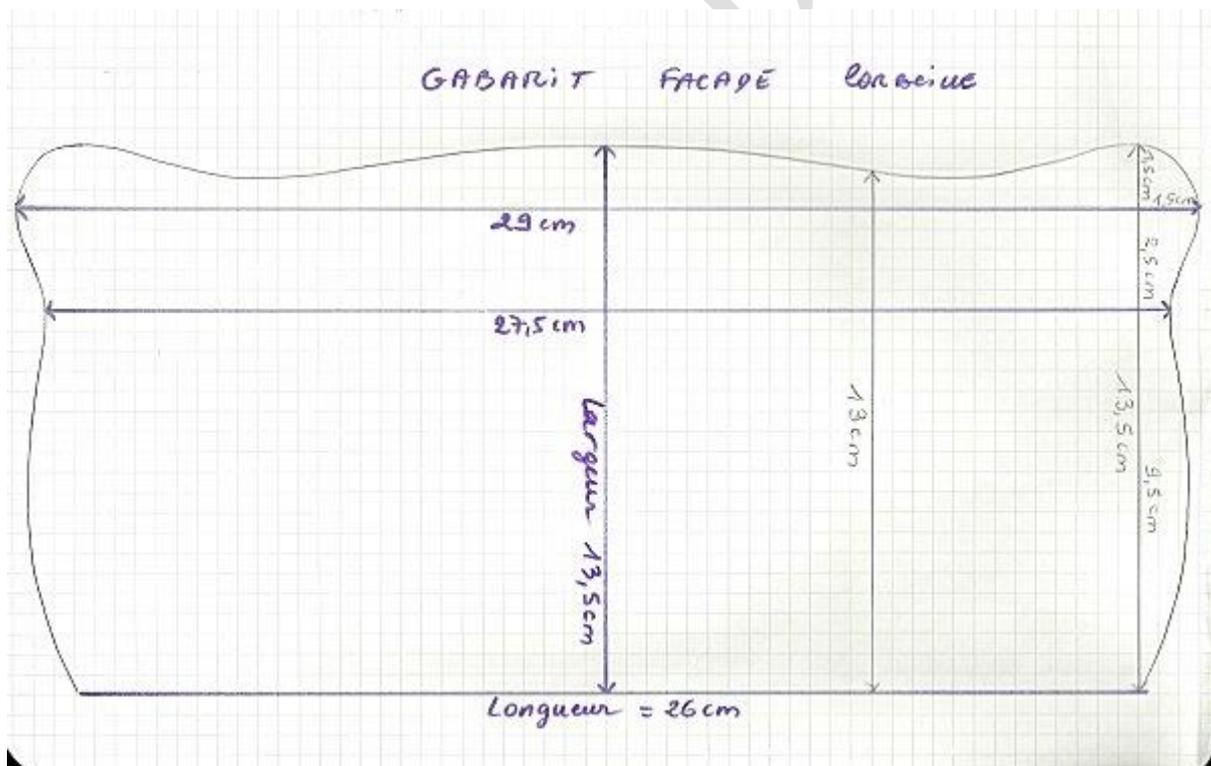
Tracer les différents éléments et reporter la forme chantournée pour les façades avant et arrière de la corbeille en se référant au gabarit. Procéder à la coupe et poncer les parties chantournées pour obtenir un mouvement courbe net.
