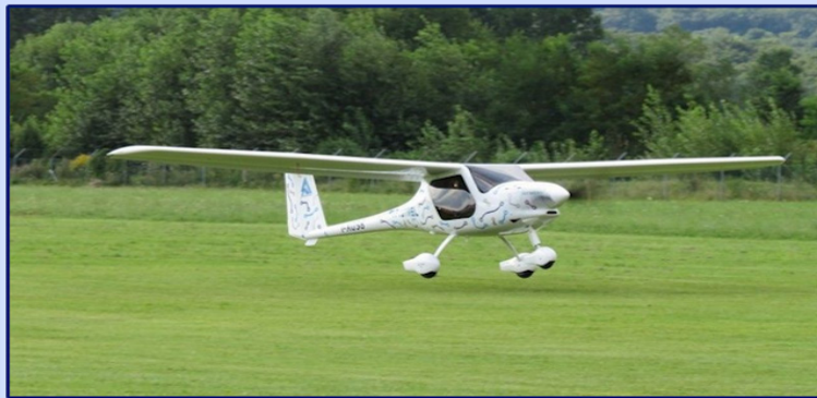
Le Pipistrel Wattsup au décollage. Son moteur, qui développe 115 ch, a une puissance largement suffisante pour ce petit avion (dérivé d'un autre modèle de la marque, l'Alpha Trainer). © Pipistrel
