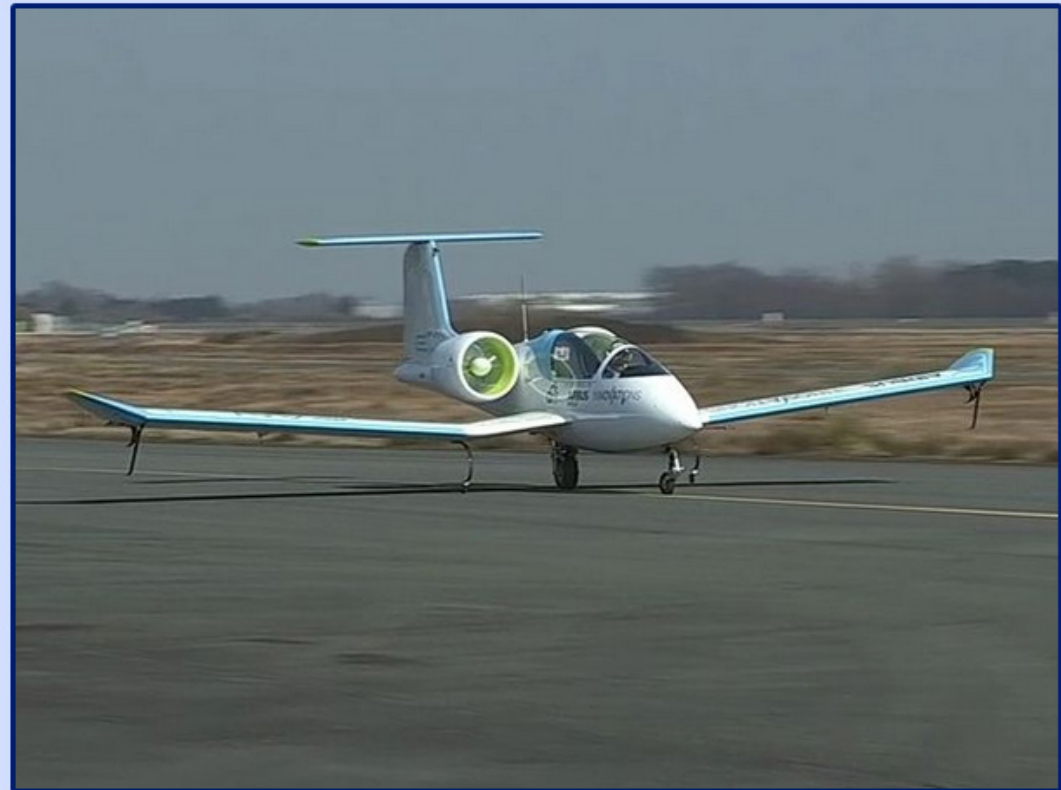
L'E-Fan lors de son premier vol le 11 mars 2014. On remarque ses hélices carénées, entraînées par deux moteurs électriques et le train d'atterrissage dit « monotrac », avec une roulette à l'avant et une roue unique à l'arrière, complétées par des balancines, c'est-à-dire des roulettes latérales portées par des tiges flexibles. Ce biplace léger de 6,70 m de long pour 9,50 m d'envergure ne pèse que 550 kg et peut voler à 220 km/h, avec une autonomie de 1 h 30. © Airbus Group
