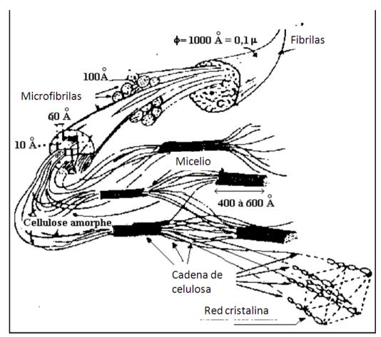
Desde la escala molecular a la microfibrila : Interior de la pared celular, A ambos lados de la capa del cambium : Formación de madera hacia el interior r y de corteza hacia el exterior de la troza
