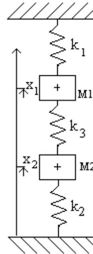
Figure n°3.1 : Oscillateur à deux degrés de liberté non amorti
