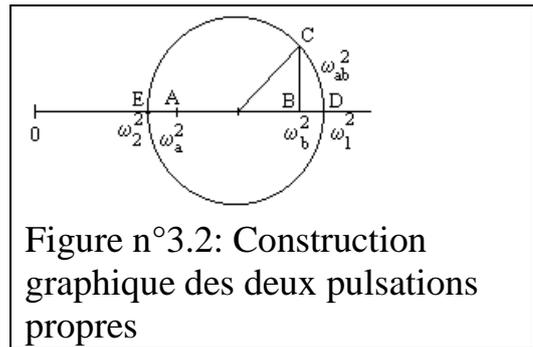
Figure n°3.2: Construction graphique des deux pulsations propres
