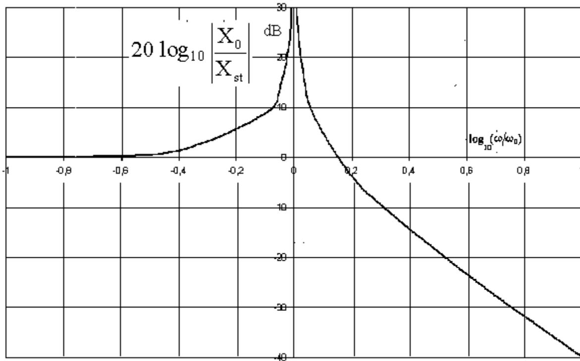
Figure n°2.4 : Amplitude du déplacement en fonction de la pulsation.
