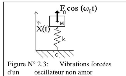
Oscillateur non amorti à un degré de liberté en vibration forcée
