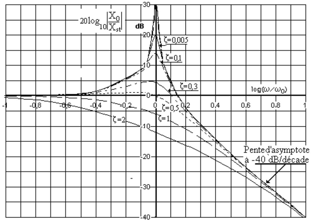
Figure n°2.6 : Amplitude du déplacement en fonction de la pulsation  $\omega$ , pour différents coefficients d'amortissement.
