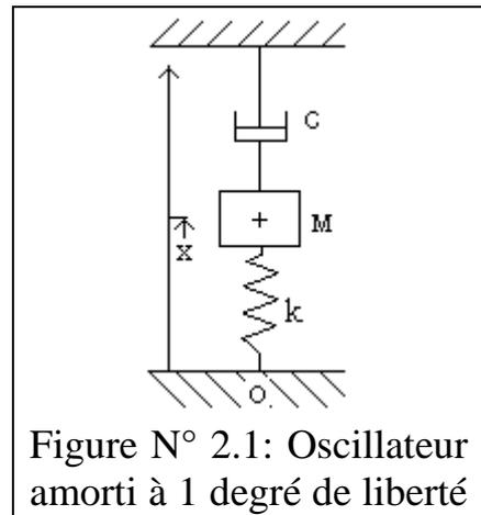
Force de rappel élastique : Le ressort, de rigidité  $k$  et de longueur  $l_0$  au repos, exerce une force de rappel supposée élastique, proportionnelle à l'allongement du ressort  $(x - l_0)$ , dirigée suivant  $o\vec{x}$  et d'intensité  $-k(x - l_0)$ .
