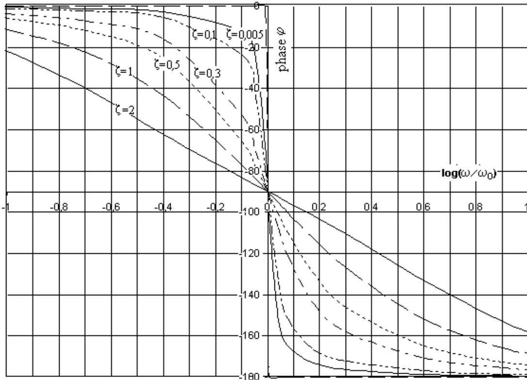
Figure n° 2.7 : Evolution de la phase en fonction de la pulsation  $\omega$ , pour différents coefficients d'amortissement.
