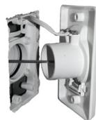
Passez une section de cintre recourbée dans la prise puis dans la plaque de montage. En retenant la plaque de montage avec le cintre recourbé, installez la prise à l'aide des vis fournies avec le kit d'installation. Ne collez pas la prise; un joint d'étanchéité est déjà installé dans la plaque de montage. Si la vis qui est à la hauteur du tuyau semble trop longue et risque de percer le tuyau, utilisez la plus petite des vis fournies avec la prise d'installation.
