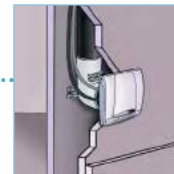
MONTAGE EN CLOISON SÈCHE
