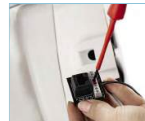
Section minimum des fils : 0,5 ou 0,75 mm 2 .
