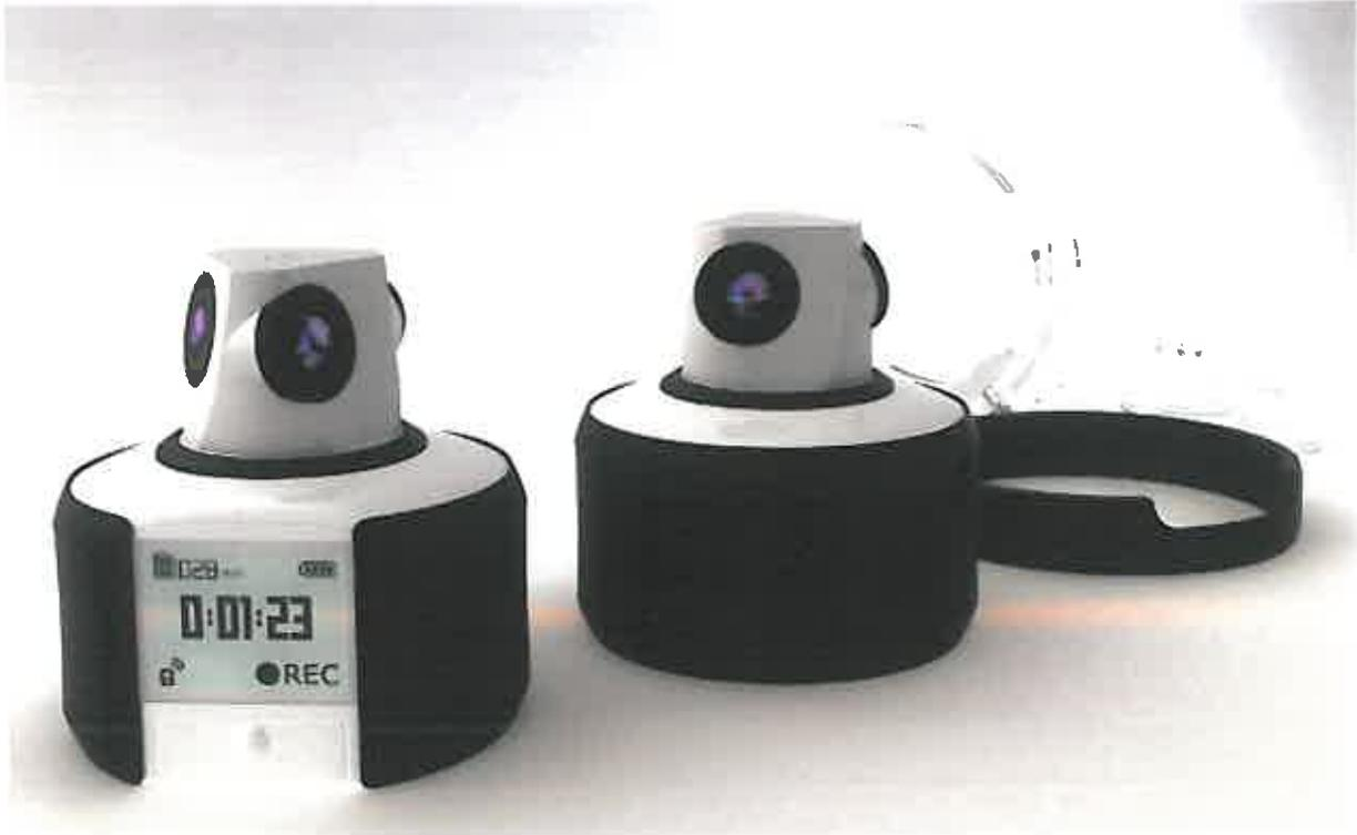
L'ensemble de l'électronique et de l'optique est monté dans un casing dont l'encombrement maximum est de l'ordre de 70x60x60mm pour un poids total (caméra + casing) avoisinant les 250g (données indicatives dépendant principalement de l'autonomie donc de la taille de la batterie)
