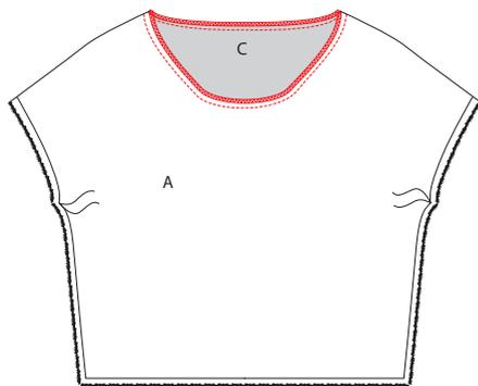
Ajoutez une piqûre parallèle à la ligne d'encolure à la largeur du pied-de-biche pour éviter l'étirement du tissu. Achevez la ligne d'encolure avec un fin point zigzag ou overlock.
