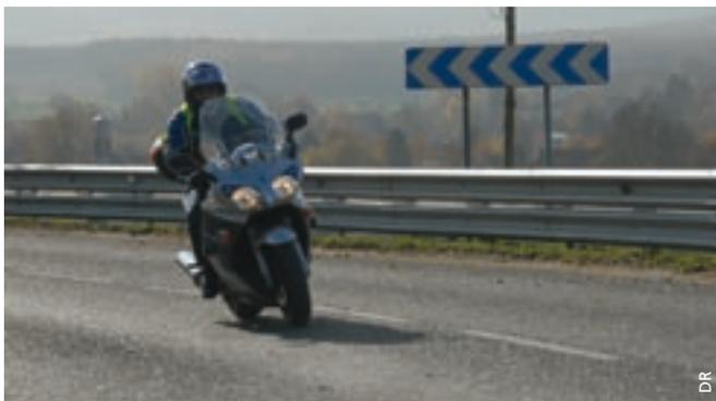
**E**n cas d'accident, la présence d'une glissière simple de sécurité, comme on en trouve en bordure de route, constitue une circonstance aggravante pour les motards, qui risquent, en dérapant, de venir s'encastrer sous la partie basse du support. Les blessures alors causées sont souvent bien plus importantes que la chute elle-même. À l'échelle nationale, on estime que ces barrières métalliques sont, chaque année, responsables de 8 % des décès de motards. La solution
