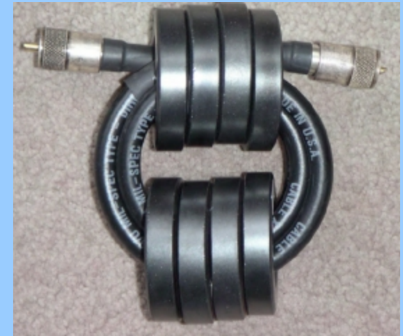
RG213 & tores mix 43 Impédance 1K de 1.8à18MHz
