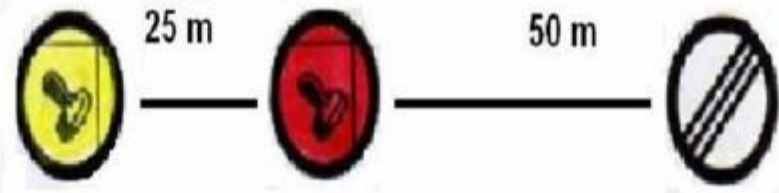
DISPOSITION DES PANNEAUX DE CONTROLE DE PASSAGE
