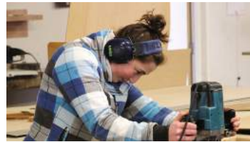
Elle utilise la défonceuse pour faire les contours de la porte.
