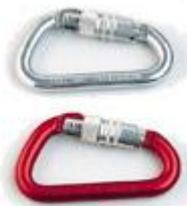
Les mousquetons simples, n'ont pas de bague qui bloque l'ouverture du doigt. Contrairement aux mousquetons de sécurité, avec une bague de verrouillage pour éviter l'ouverture involontaire avec le doigt. On distingue le mousqueton semi-automatique: la bague de sécurité doit être tournée d'un demi tout pour se déverrouiller et le mousqueton à vis ou l'on doit entièrement dévisser la bague
