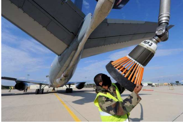
L'ORV est en charge de la vérification des paniers de ravitaillement avant le vol
