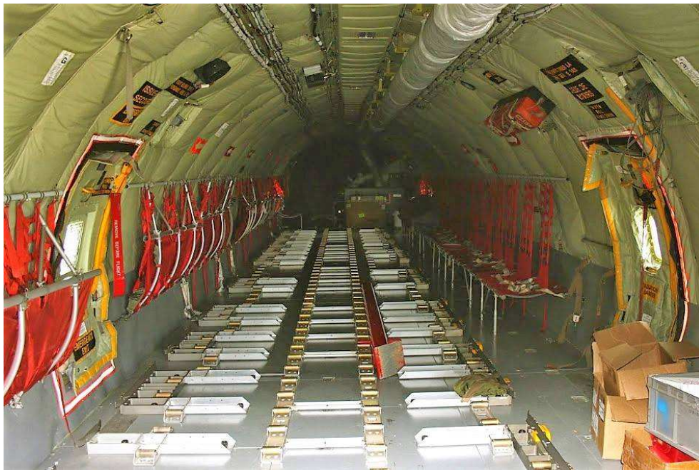
Système d'arrimage de fret et de transport de troupe sur banquette repliée, des sièges façon avion civils pouvait être aussi installé pour un transport plus confortable
