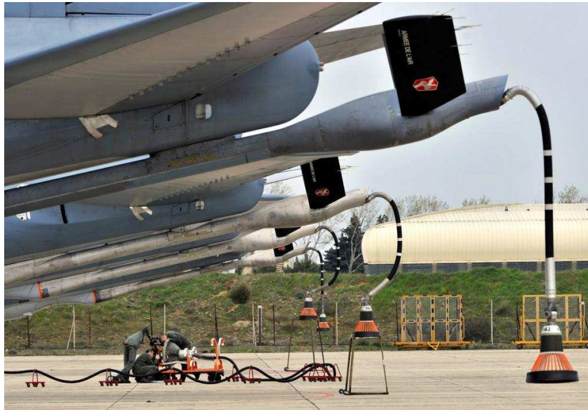
Le système Probe and Drogue adapté en bout de perche rigide
