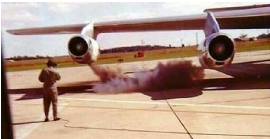
Démarrage cartouche d'un J57, l'ordre de démarrage était 4/3/2/1
