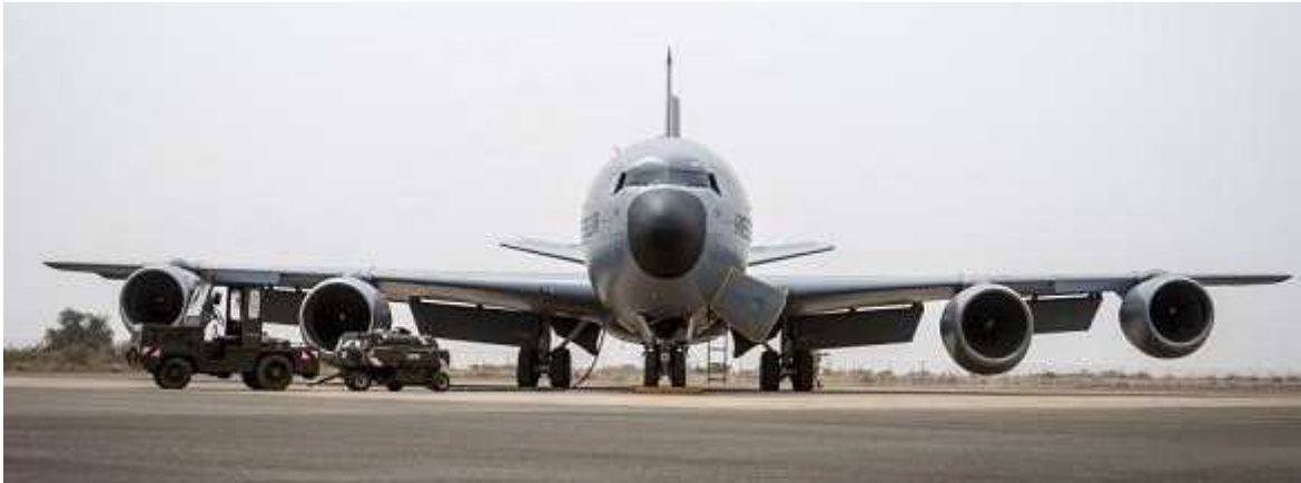
Prêt à partir avec la trappe d'accès de l'équipage ouverte échelle en place
