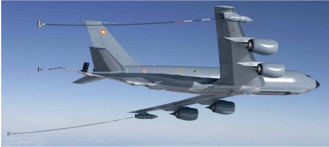
Les tuyaux des deux nacelles déployés
