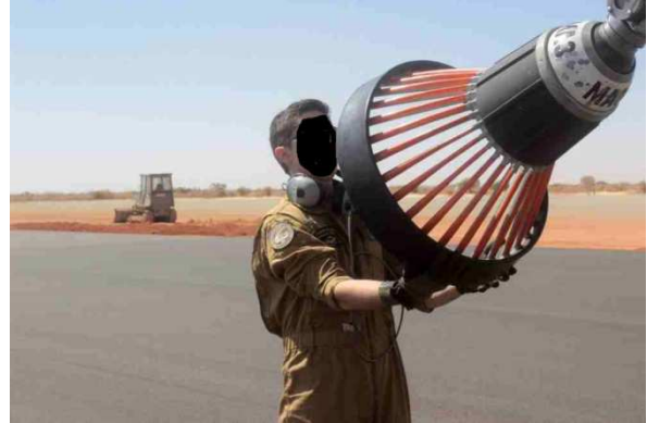
L'ORV est en charge de la vérification des paniers de ravitaillement avant le vol
