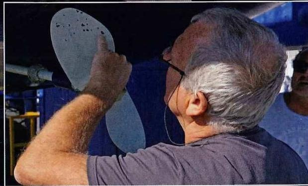
M. Pomarède profite de la mise sur sangles pour contrôler l'hélice MaxProp, un must indéniable pour les performances sous voiles et au moteur. On ne remarque que quelques petits éclats de peinture sans conséquence.
