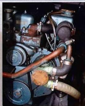
Le moteur Perkins IB-4.108 de 50 Ch monté sur embase sail-drive est d'origine et affiche un aspect plutôt rassurant malgré quelques traces de rouille. L'expert préconise une révision globale et précise que ces moteurs, dont la sortie de vilebrequin est sur presse-étoupe, perdent généralement de l'huile en petite quantité, ce qui est normal.
