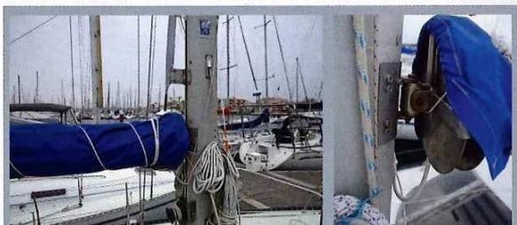
La grand-voile est sur enrouleur de bôme, système généralement plus performant que les enrouleurs de mât, car la GV peut être lattée. Notre expert préconise le remplacement de l'axe au vit de mulet qui présente des traces de rouille.
