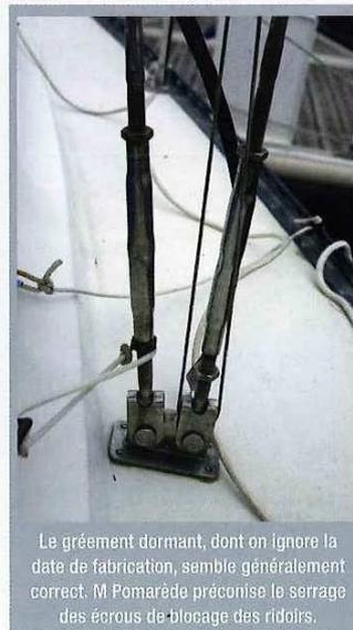
Le gréement dormant, dont on ignore la date de fabrication, semble généralement correct. M. Pomarède préconise le serrage des écrous de blocage des ridoirs.
