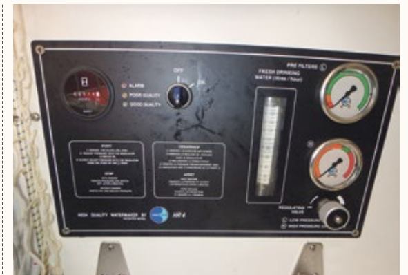
Le dessalinisateur, un Dessalator HR4 produisant 140 l/h est un modèle très répandu réputé efficace. Une preuve de plus de l'orientation voyage de ce Bavaria.
