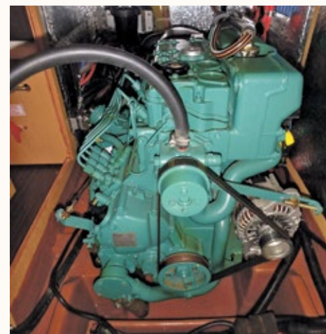
Le moteur Volvo D2-55F n'affiche que 830 heures et semble avoir été bien entretenu. Les essais effectués par M Pomarède montreront « une bonne reprise, puissance, pas de vibration ». Le résultat des analyses d'huile est très satisfaisant.
