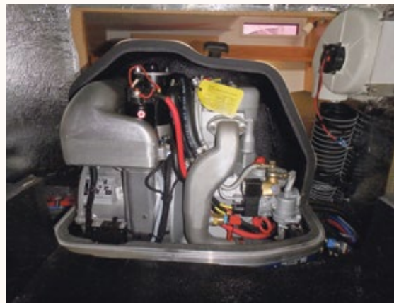
Un groupe électrogène Fisher Panda 4000S en excellent état vient parfaire un équipement déjà très fourni.
