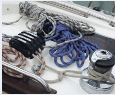
Piano Spinlock, winches self-tailing Lewmar et manœuvres courantes sont en très bon état, tout comme les hublots en plexyglas.
