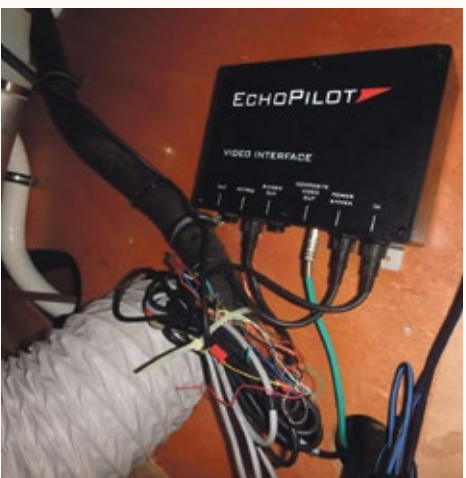
Cette box d'interface vidéo EchoPilot laisse supposer la présence d'un module ForwardScan (sondeur avant) couplé à la centrale Raymarine, un atout pour éviter les collisions avec les OFNI ou les roches mal cartographiées.
