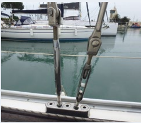
Les ridoirs, cadènes, et haubans sont en bon état, exempts des traces brunes habituelles.
