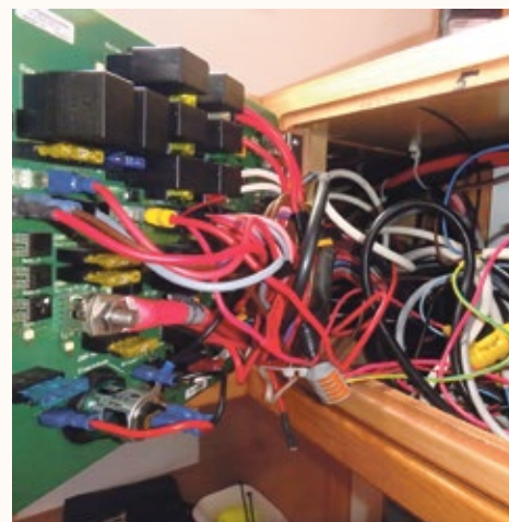
On voit ici en bas une cosse rouge non connectée ainsi qu'une connexion positive non isolée un peu plus haut, symptomatique de quelques branchements bidouille. Notre expert préconisera donc « l'isolation des fils à l'arrière du tableau électrique de la table à carte ».
