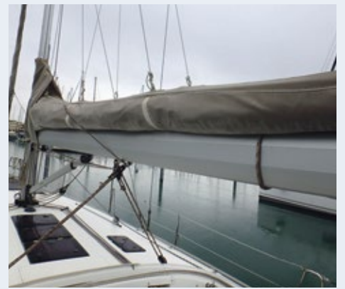
Le lazy bag est impeccable. On note la présence d'un hale-bas rigide Selden.
