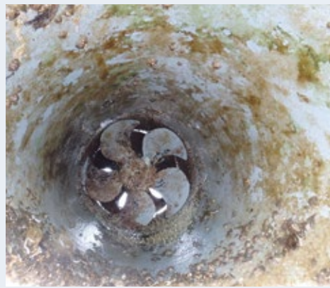
Le propulseur d'étrave, un Side Power, est un modèle en tunnel.
