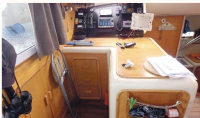
Le coin navigation, sur bâbord en entrant, intègre tout ce qu'il faut : outre un magnifique traceur de carte multifonction HybridTouch de Raymarine, doté d'une caméra extérieure, du radar et du sondeur graphique, on trouve une VHF fixe R04800, une télécommande de pilote, un ensemble stéréo/vidéo avec écran tactile Pioneer, un récepteur SSB Sangean, un gestionnaire de batterie et de chargeur, bref, rien ne manque. D'autant que tout ceci est complété par un iPad sur support orientable.
