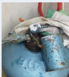
La bouteille de gaz montre certes quelques signes de corrosion, le rapport préconise d'ailleurs le remplacement des tuyaux et la pose d'un robinet d'arrêt dans la cuisine, mais il s'agit d'une grosse 13 kg qui montre bien l'aptitude et le passé de voyageur du catamaran.
