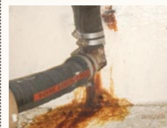
Les moteurs sont sans doute les éléments les plus marqués par le temps, avec notamment « les coudes d'échappement perforés à bâbord et à tribord (prévoir remplacement), le coude sur tuyau d'échappement percé avec traces de rouille en fond de cale. » Des travaux effectués sans délai par le nouveau propriétaire. L'expert préconise en outre une peinture et une révision générale sur les blocs moteur.
