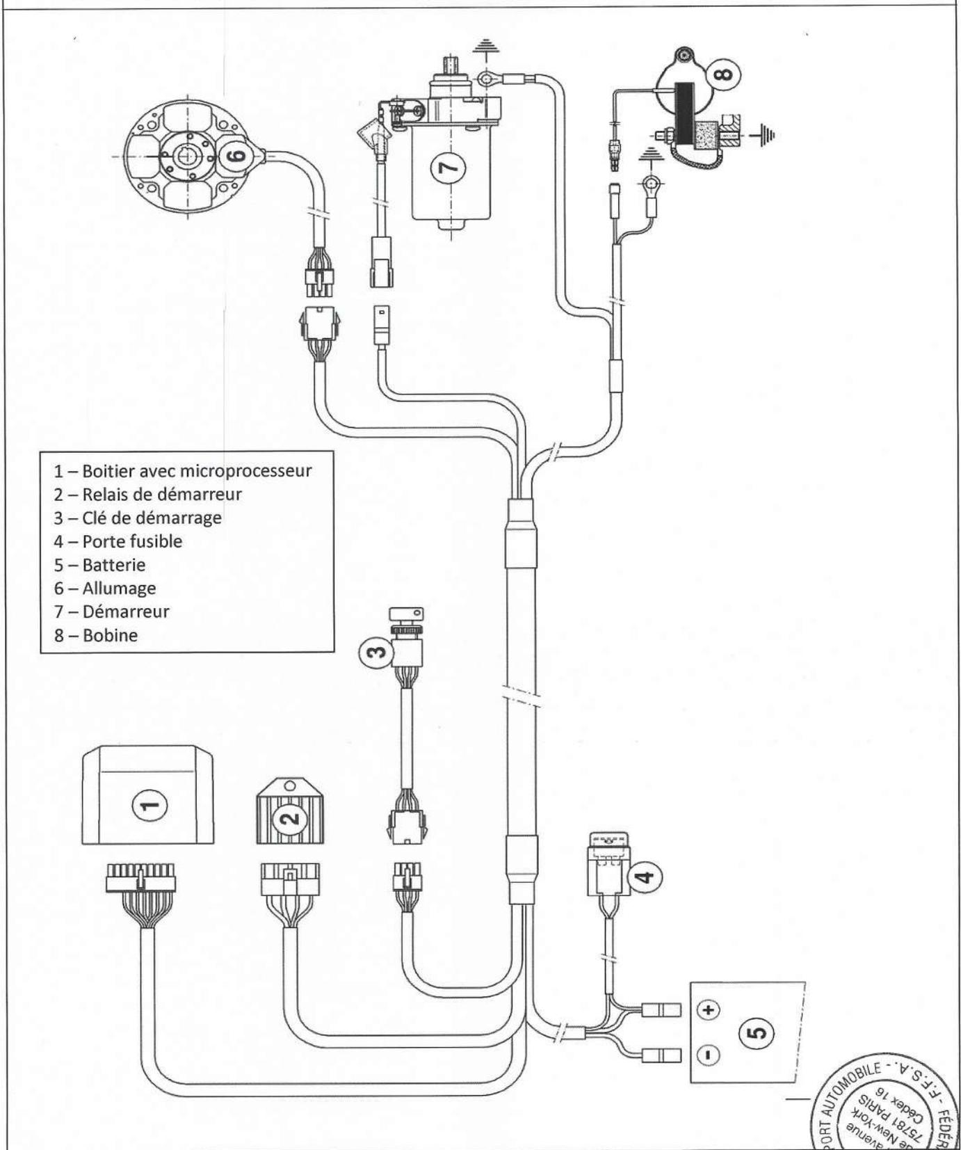
L'allumage K3 monté avec un adaptateur (repéré 301 dans le schéma K3) est conforme avec l'ensemble K1.
