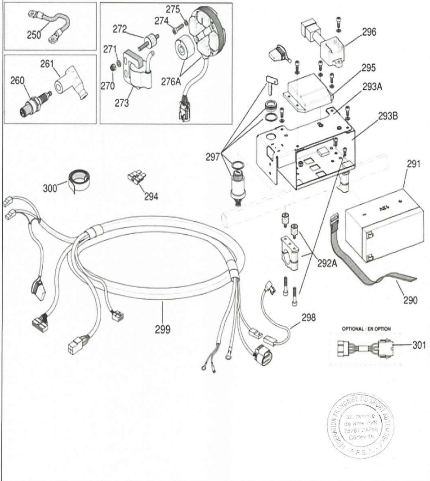
L'allumage K1/K2 monté avec un adaptateur (repéré 301) est conforme avec l'ensemble K3.
