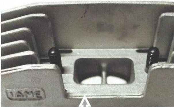
Plan de joint échappement brut de sablage
