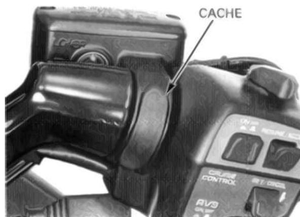
Installez la masselotte extérieure de poignée sur la masselotte intérieure, en alignant les bossages et les rainures. Installez une vis de montage neuve et serrez-la tout en immobilisant la masselotte.
