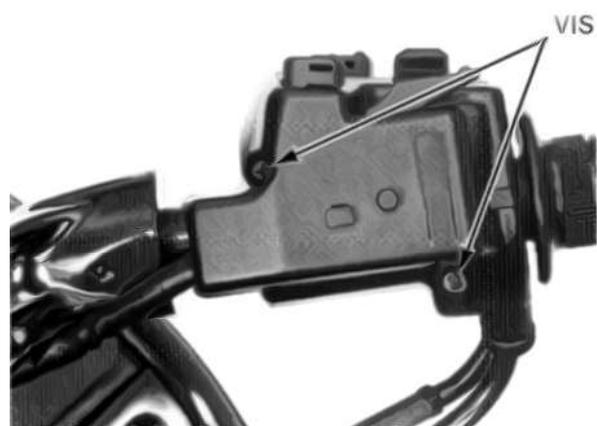
Déposez la vis et la plaque de réglage du commutateur de guidon droit.
