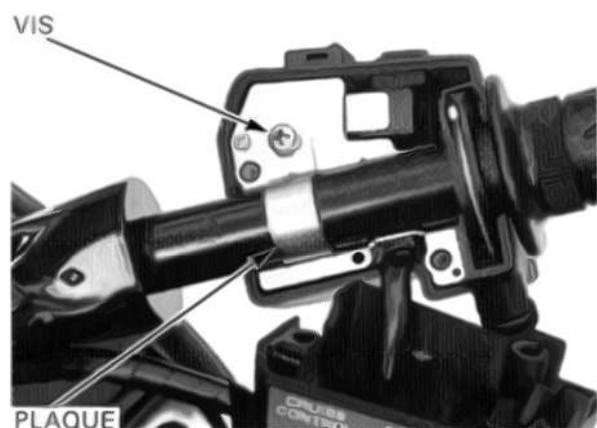
Déposez la manette des gaz du guidon droit et débranchez les câbles d'accélérateur de la bride de manette des gaz. Déposez la manette des gaz du tuyau des gaz.
