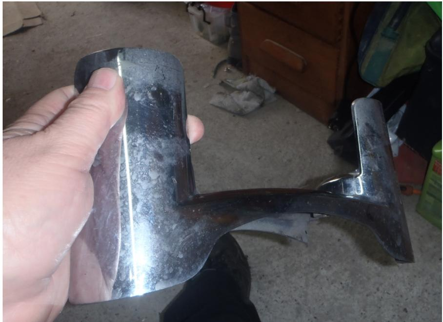
Et voilà a priori d'après les atticles sur les forums cela permet de rigidifier la fourche et d'avoir une meilleure maniabilité a petite vitesse et moins de flottement a vitesse plus rapide (reste plus qu'a essayé demain en allant au boulot car aujourd'hui la 15 est resté au garage vu les avis de tempête sur l'Est et étant de service à Sélestat
