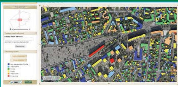
25% à 30% des déperditions thermiques totales d'un bâtiment passent par sa toiture. Connaître le niveau de déperdition de la toiture, c'est avoir un bon indicateur de la déperdition globale du bâtiment, et donc de la qualité de son isolation.
