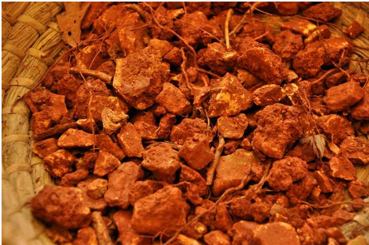
Figure 10 – impuretés : feuilles, radicelles, fragments de calcaires et de silex - Cliché J.Vosges
