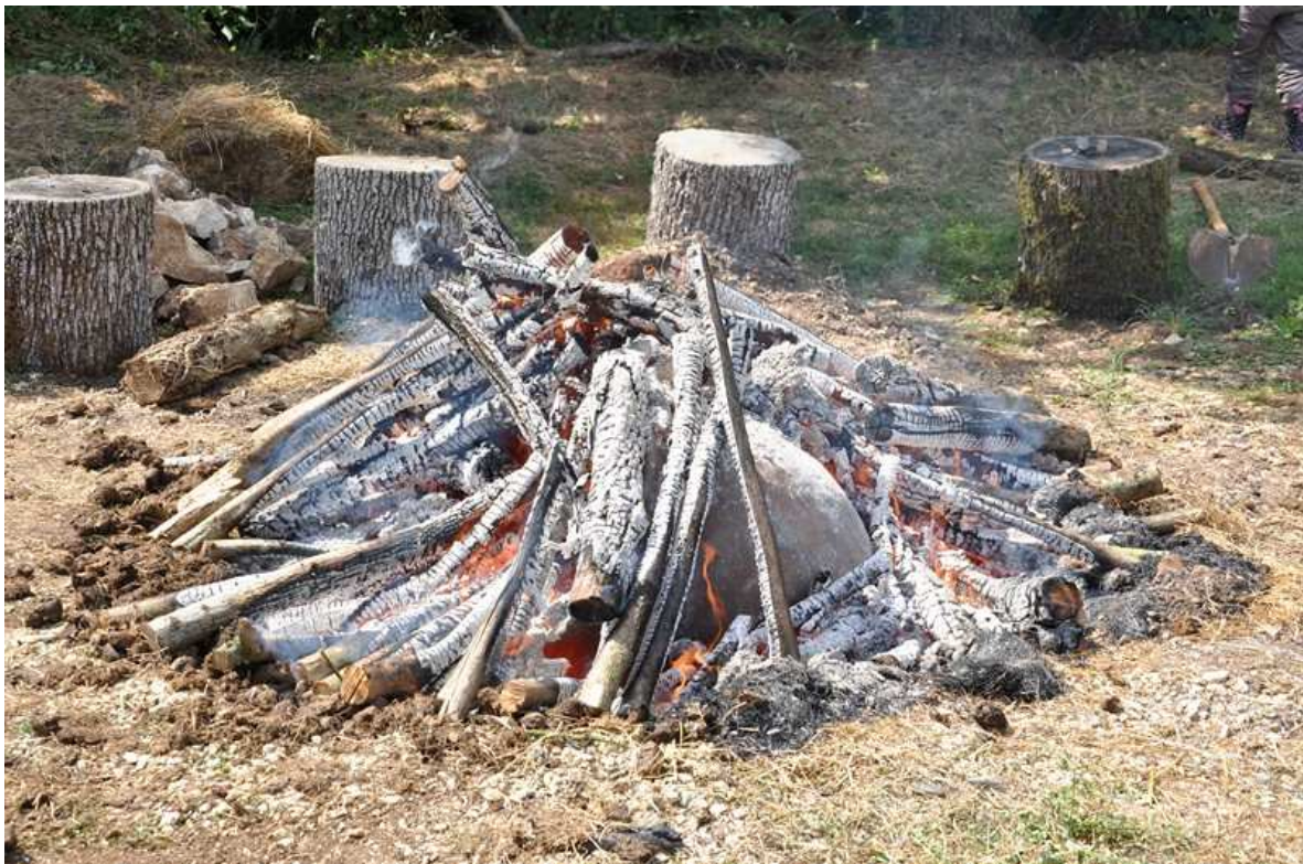
Figure 25 – embrasement de la meule - Cliché J.Vosges
