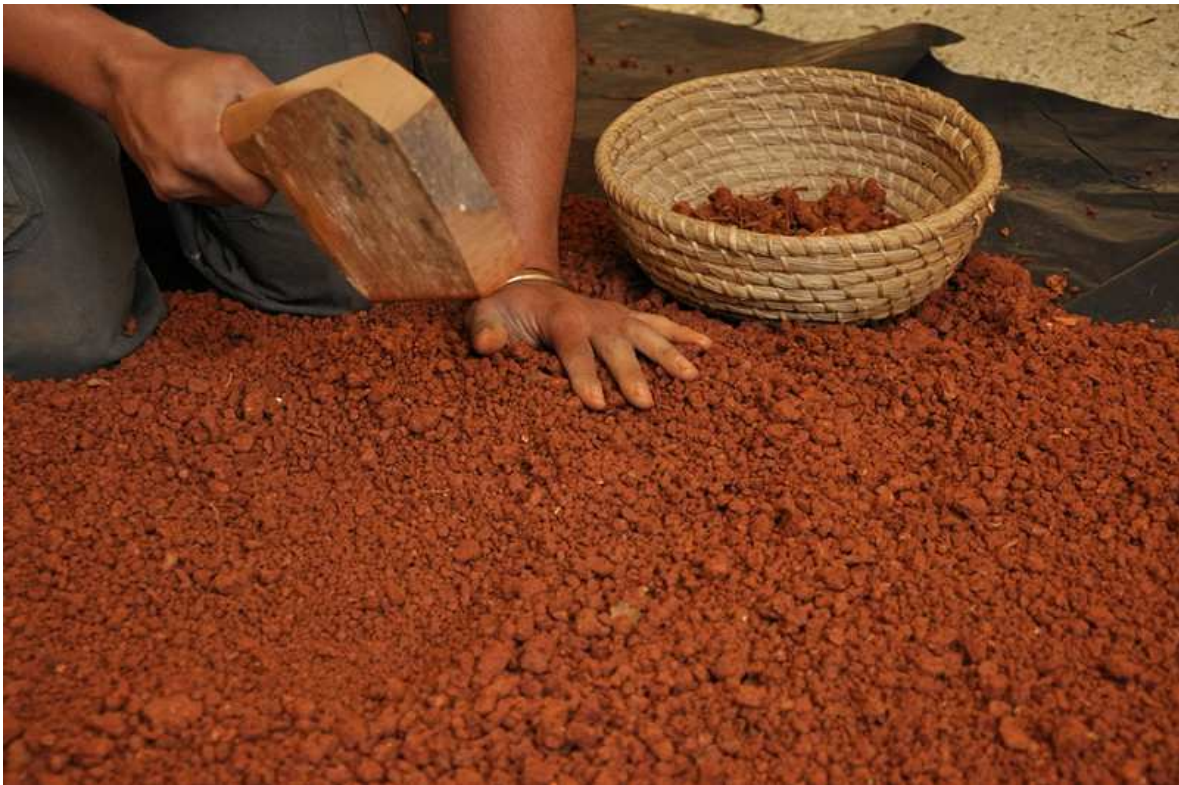
Figure 9 – concassage et tri de l'argile - Cliché C.Albaret
