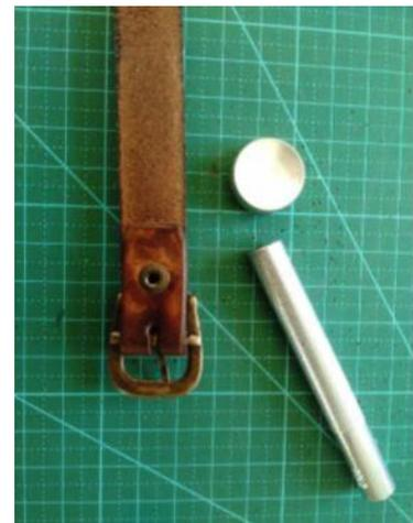
On colle les deux bords et on fixe un rivet (qui passe dans le trou de la chape métallique de la boucle) avec l'enclume et le manche à frapper.
