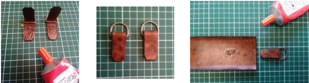
Gratter au cutter les surfaces à encoller, laisser sécher puis mettre en place des supports d'anneaux.
