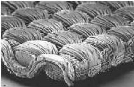
Fig54/ZZ44 : Observation en Microscopie à Balayage d'un tissu Dacron tissé serré. On y voit un fil de chaîne en coupe sur le bord.
