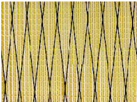
Fig55/ZZ46 : Cuben Fiber (Spectra traité anti-glissement / Mylar).
